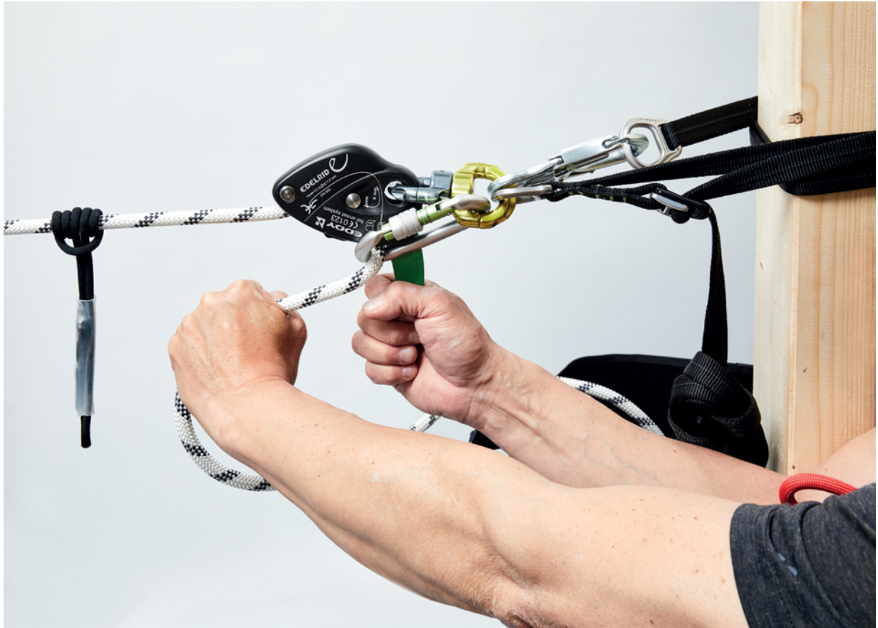
Bild 11.: Ablassen eines Verletzten
