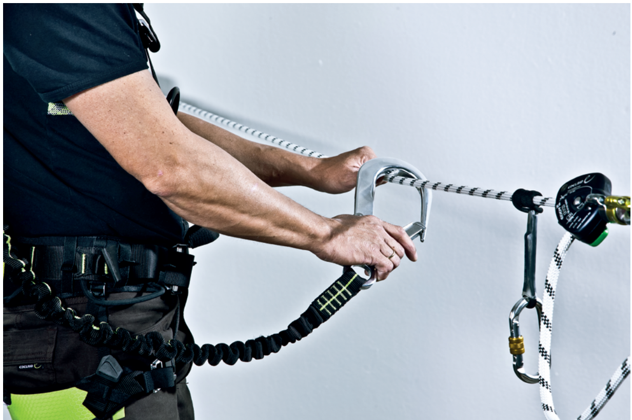
Bild 9: Anschlagen an der Lifeline mit Verbindungsmittel
