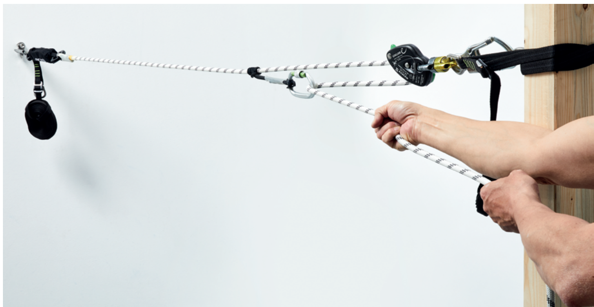
Bild 7: Spannen des HOLD®-system von Hand durch eine Person
